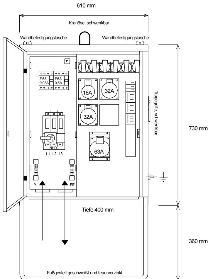
FI-Schalter Typ A sind nicht für den Betrieb Frequenzumrichter gesteuerter Betriebsmittel geeignet!
