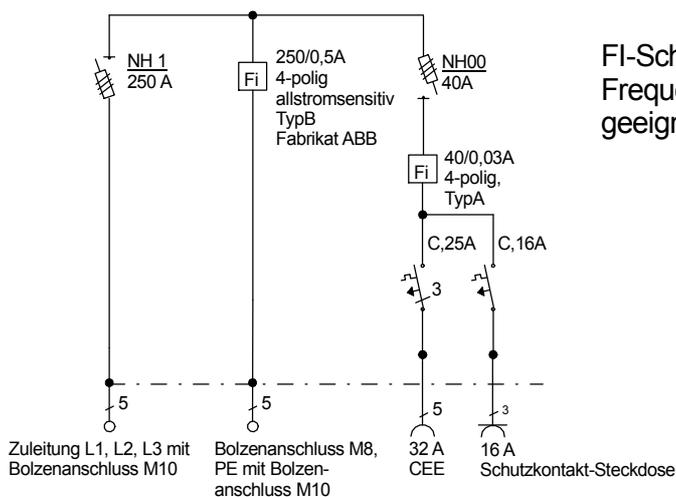
FI-Schalter Typ A sind nicht für den Betrieb Frequenzumrichter gesteuerter Betriebsmittel geeignet!
