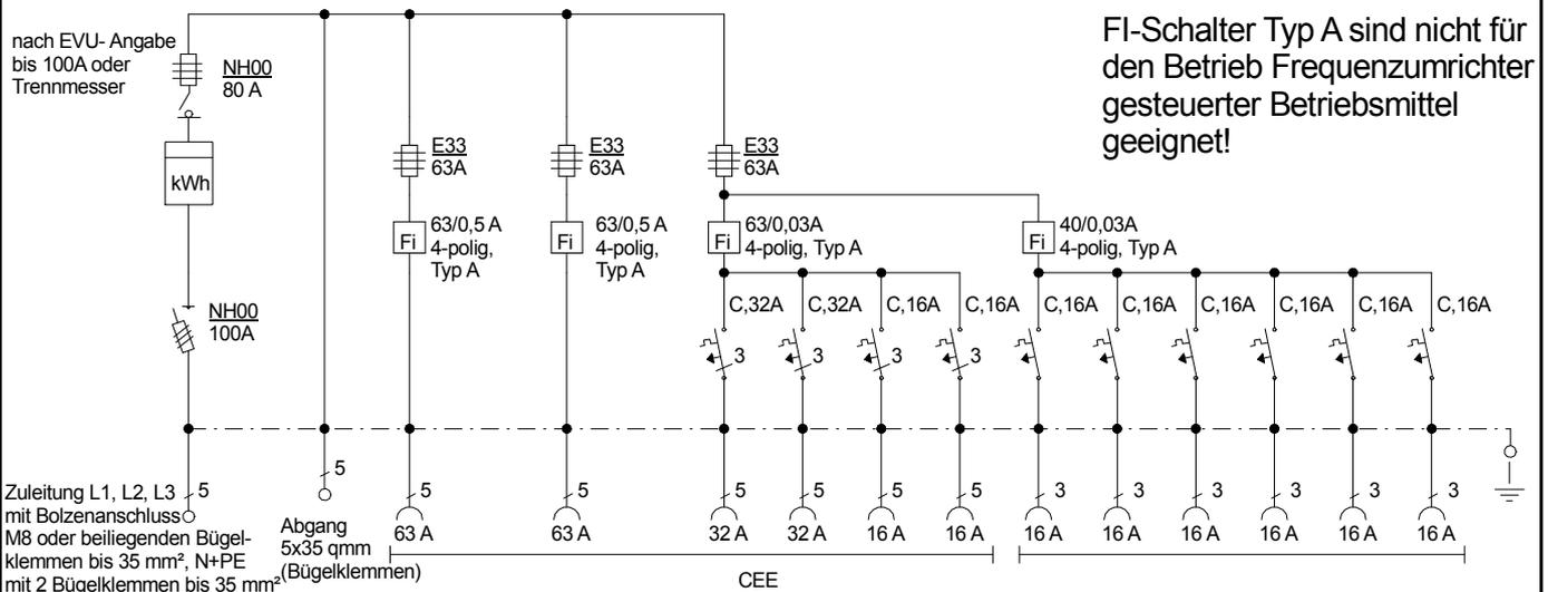
FI-Schalter Typ A sind nicht für den Betrieb Frequenzumrichter gesteuerter Betriebsmittel geeignet!
