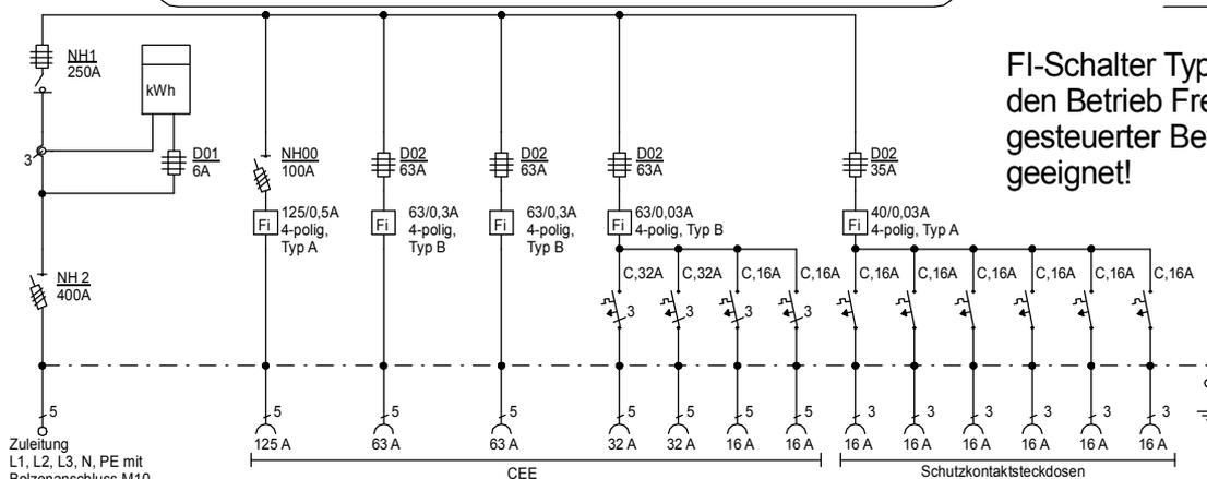
FI-Schalter Typ A sind nicht für den Betrieb Frequenzumrichter gesteuertes Betriebsmittel geeignet!
