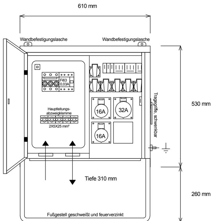
FI-Schalter Typ A sind nicht für den Betrieb Frequenzumrichter gesteuerter Betriebsmittel geeignet!
