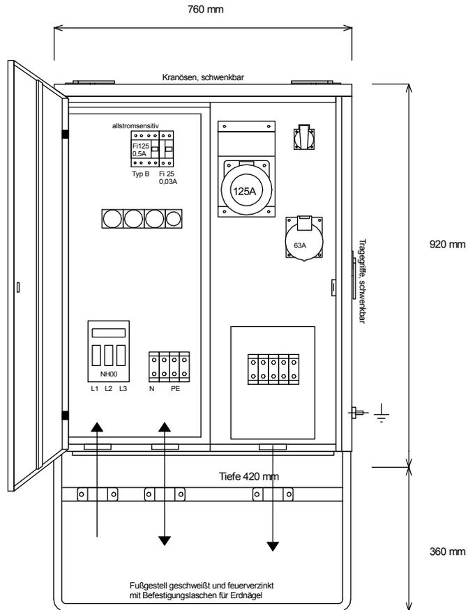
FI-Schalter Typ A sind nicht für den Betrieb Frequenzrichter gesteuerter Betriebsmittel geeignet!
