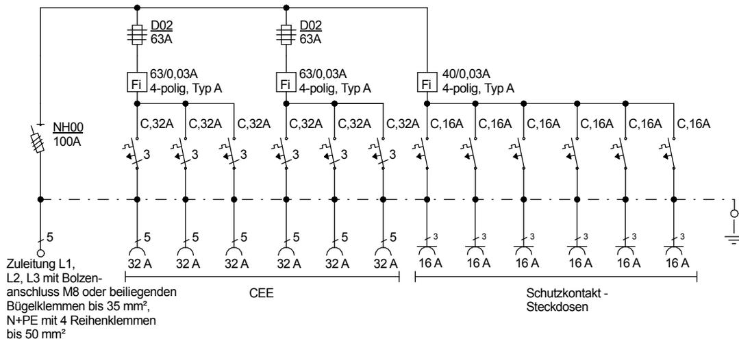
FI-Schalter Typ A sind nicht für den Betrieb Frequenzumrichter gesteuerter Betriebsmittel geeignet!
