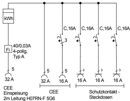
FI-Schalter Typ A sind nicht für den Betrieb Frequenzumrichter gesteuerter Betriebsmittel geeignet!
