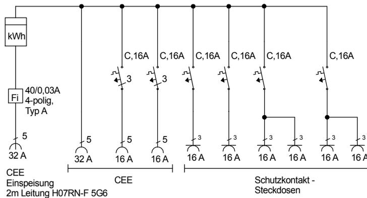
FI-Schalter Typ A sind nicht für den Betrieb Frequenzumrichter gesteuerter Betriebsmittel geeignet!
