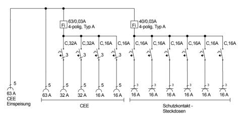
FI-Schalter Typ A sind nicht für den Betrieb Frequenzumrichter gesteuerter Betriebsmittel geeignet!
