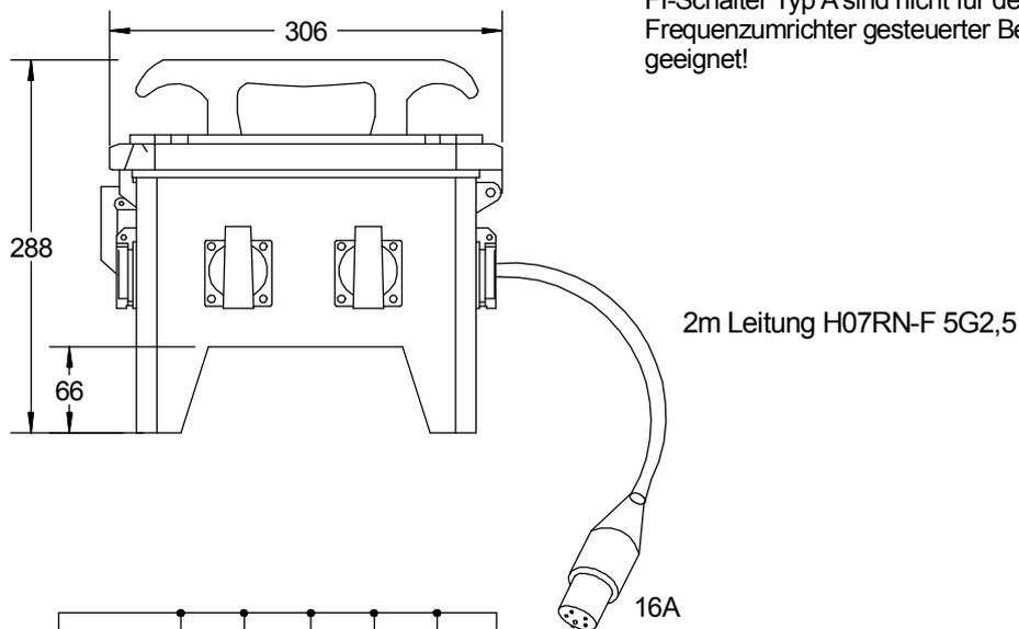
FI-Schalter Typ A sind nicht für den Betrieb Frequenzumrichter gesteuerter Betriebsmittel geeignet!
