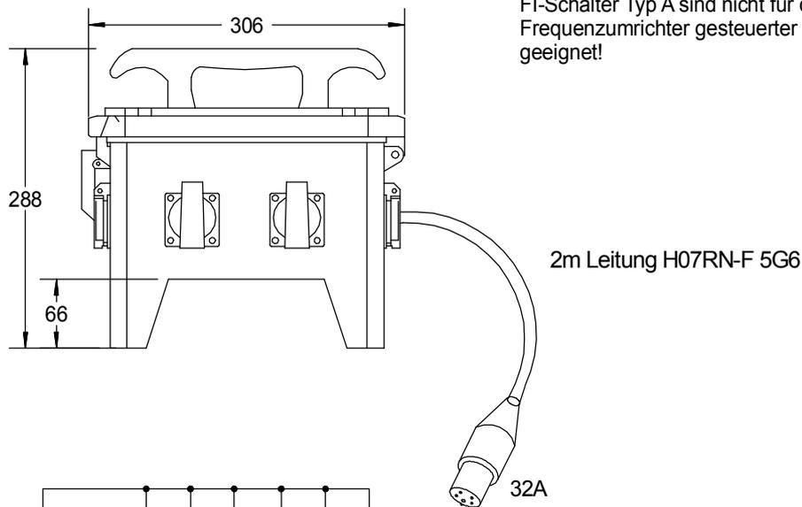
FI-Schalter Typ A sind nicht für den Betrieb Frequenzumrichter gesteuerter Betriebsmittel geeignet!
